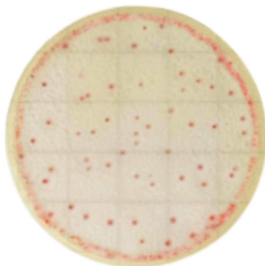
菌落数= 多不可计 (TNTC) 测试片上菌落高密度分布在边缘区域, 判读时容易忽略, 若出现应记录为多不可计。
